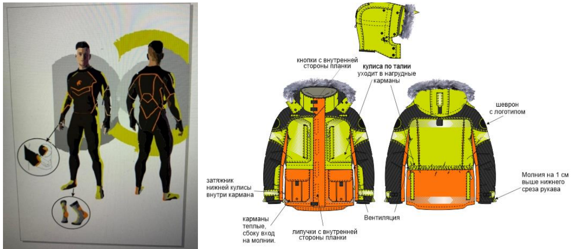
Рисунок 17 Теплозащитный комплект одежды с зональным инкапсулированием термобелья и термоносков элементами с изменяемым фазовым состоянием
