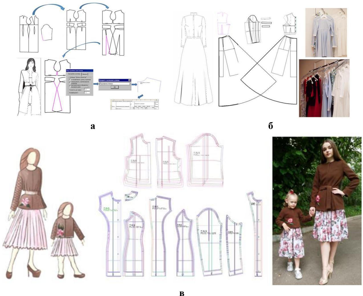
Рисунок 9 – Конструирование в «Eleandr CAD»: а) виртуальное моделирование; б) цифровое описание конструкции; в) градация деталей женского и детского пальто
